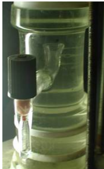
Bild 5.22 Abscheider zur Phasentrennung mit 200 mm Durchmesser (links), 50 mm (rechts)
