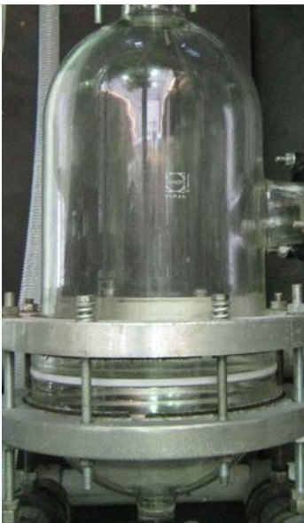
Bild 5.22 Abscheider zur Phasentrennung mit 200 mm Durchmesser (links), 50 mm (rechts)
