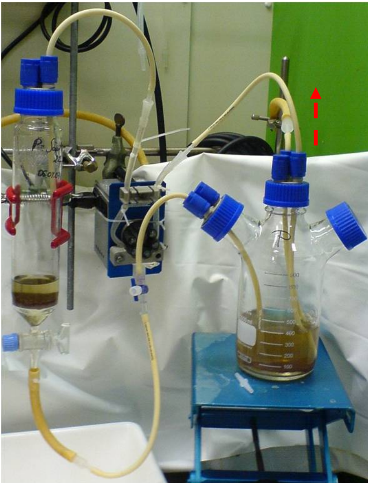
Bild 6.3 Bioleachingreaktor im Labormaßstab. Perkolator mit permeabler Glasfritte und Asche. Bakterienlösung befindet sich im belüfteten Reaktor (Fließrichtung roter Pfeil).
