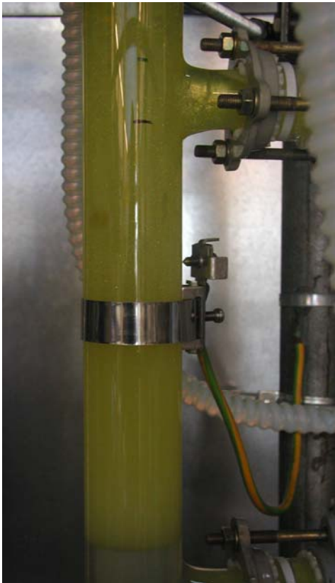
Bild 5.28 Fluten der Kolonne ohne Einbauten
