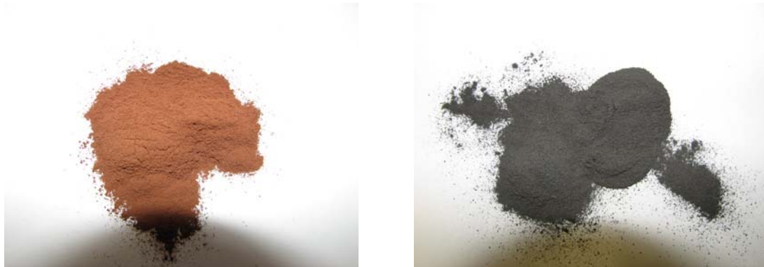
Bild 4.54 Klärschlammasche vor der Reduktion (links) und nach der Reduktion (rechts)
